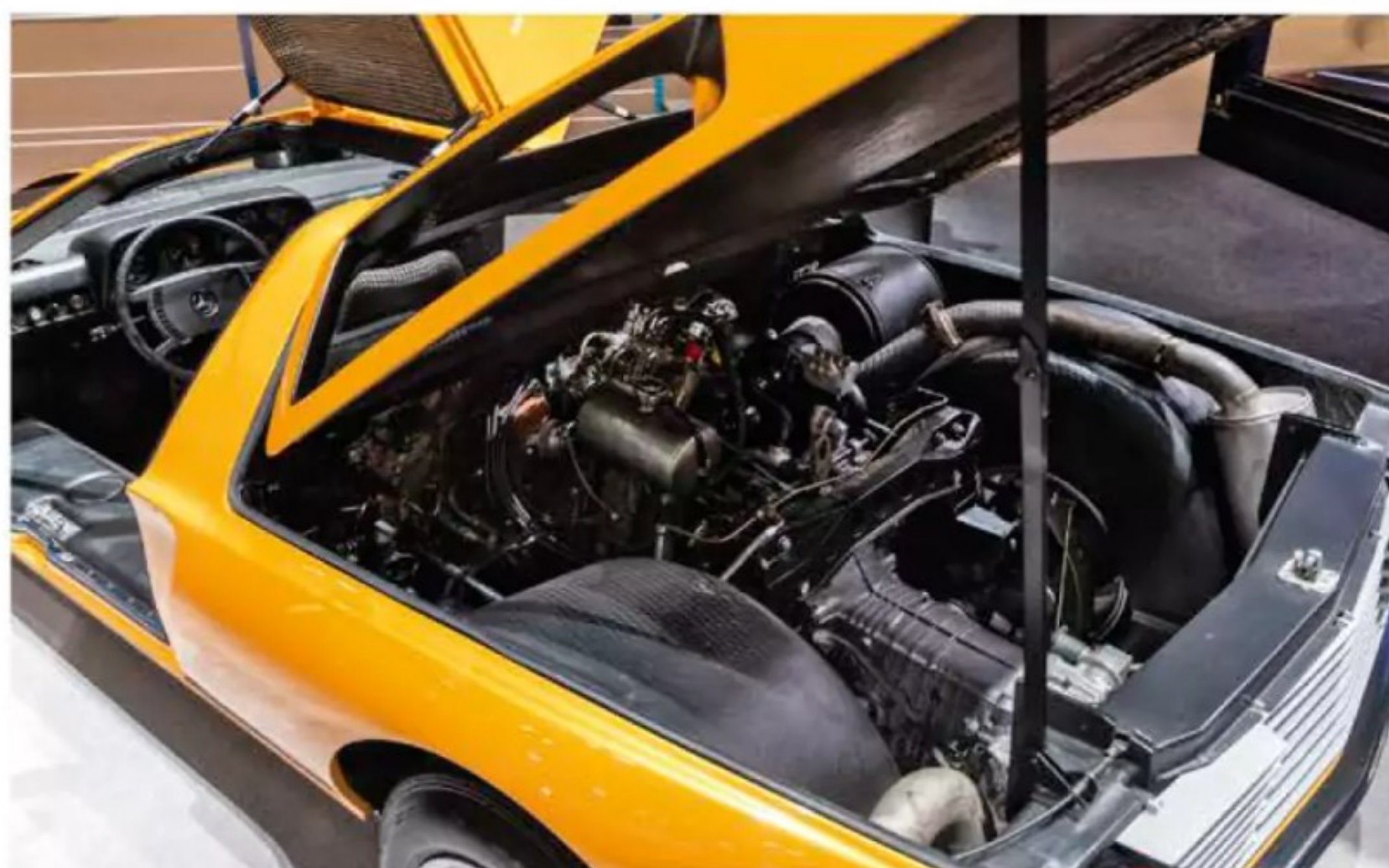
La présence d'un moteur Wankel dans le C111 prouve l'ouverture d'esprit technique de Mercedes-Benz.
