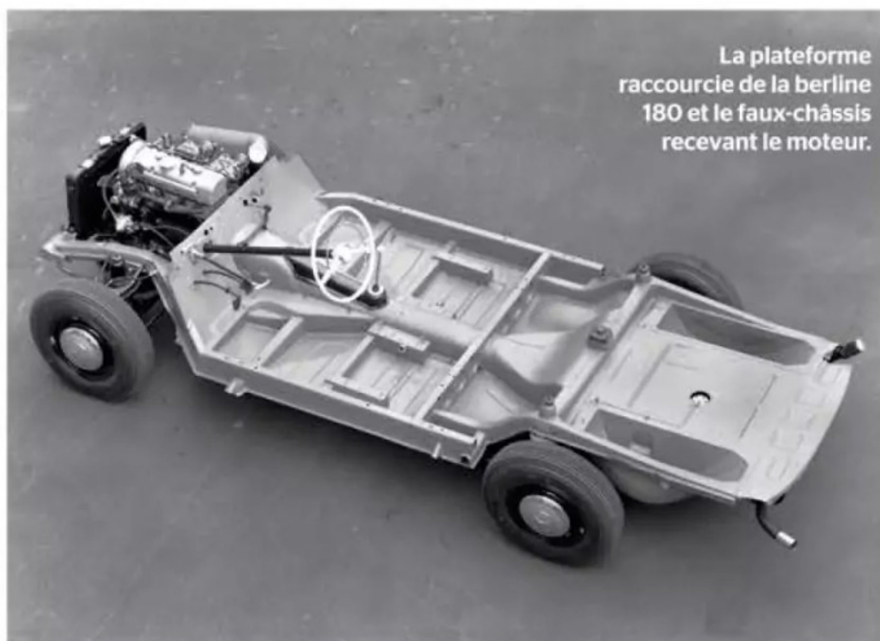
La dernière version du 4 cylindres 1900 cm 3 poussé à 105 ch.
