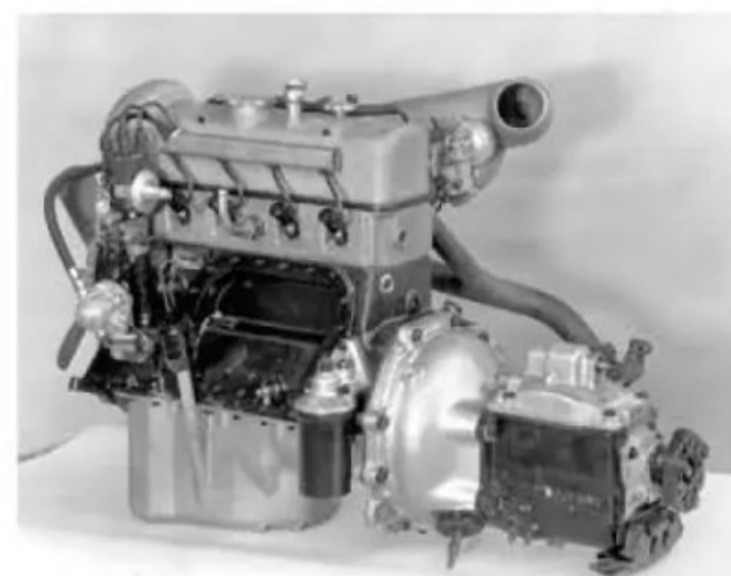
La dernière version du 4 cylindres 1900 cm 3 poussé à 105 ch.
